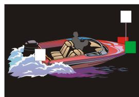
oder die **Seitenlichter** unmittelbar **nebeneinander** oder als „Zweifarbenerlaterne“ am oder nah am Bug in der Schiffsachse das **Topplight** mindestens einen Meter über den „Seitenlichtern“ das **Hecklicht**
