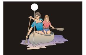
Kleinfahrzeug stillliegend auf der Fahrwasserseite ein von allen Seiten sichtbares weißes gewöhnliches Licht dieses Licht kann entfallen, wenn:
