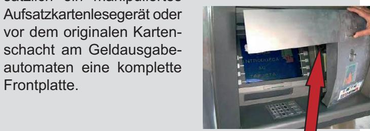
Daran schließt sich das Ausspähen der PIN an, wofür die Täter unter Zuhilfenahme von fototechnischen Modulen, z. B. Kamera, Fotohandy, die Eingabe der PIN am Automaten optisch erfassen.
