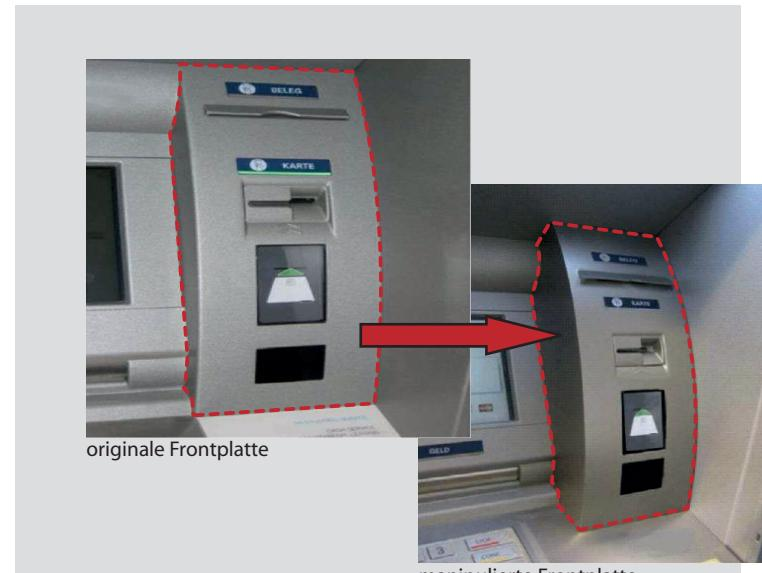
Skimming richtet sich zunächst auf das Ausspähen gespeicherter Daten, die sich auf dem Magnetstreifen der Zahlungskarten befinden. Dies geschieht vor allem durch den Einsatz kleinerer elektronischer Bauteile, die rund um die Lesemodule für Zahlungskarten am Geldausgabeautomaten oder anderen Lesegeräten, z. B. an den Eingangstüren, angebracht werden.
